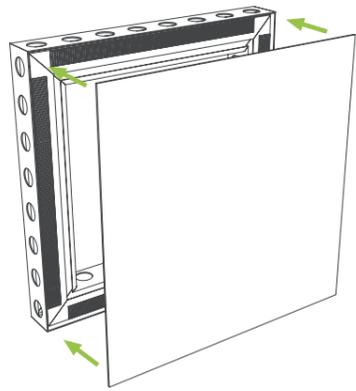
Paneele werden mit Klettband befestigt.
